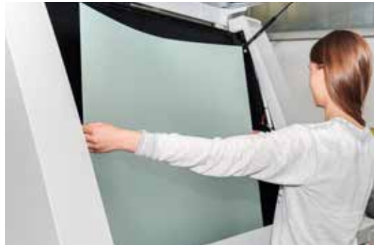
Eine Mitarbeiterin lädt eine prozessfreie KODAK SONORA UV Platte in den KODAK TRENDSETTER 800 II Quantum Plattenbelichter
